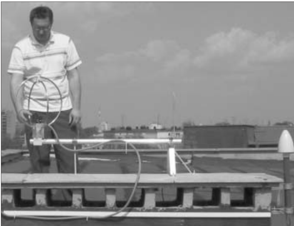
Końcowe kalibrowanie sensora pola magnetycznego na budynku Wydziału Elektrotechniki i Informatyki.
