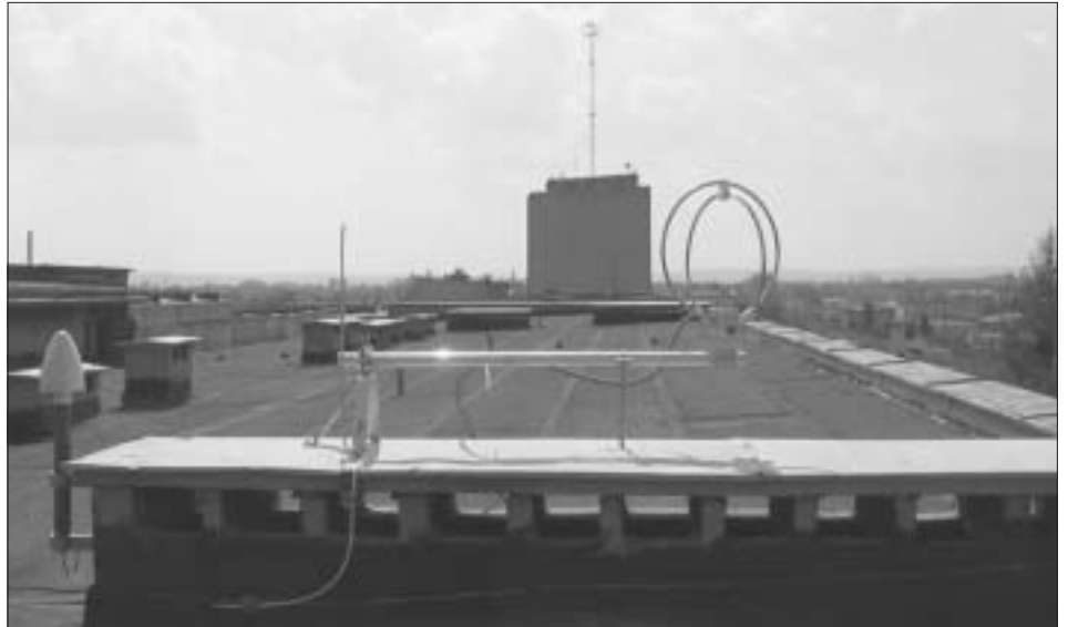
Dwie wzajemnie prostopadłe pętle rejestrują pole magnetyczne w zakresie fal VLF/LF – widok z dachu WEiI.
