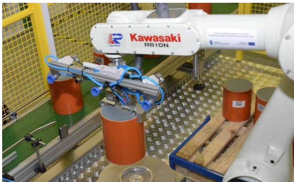
Robot podczas procesu paletyzacji.
