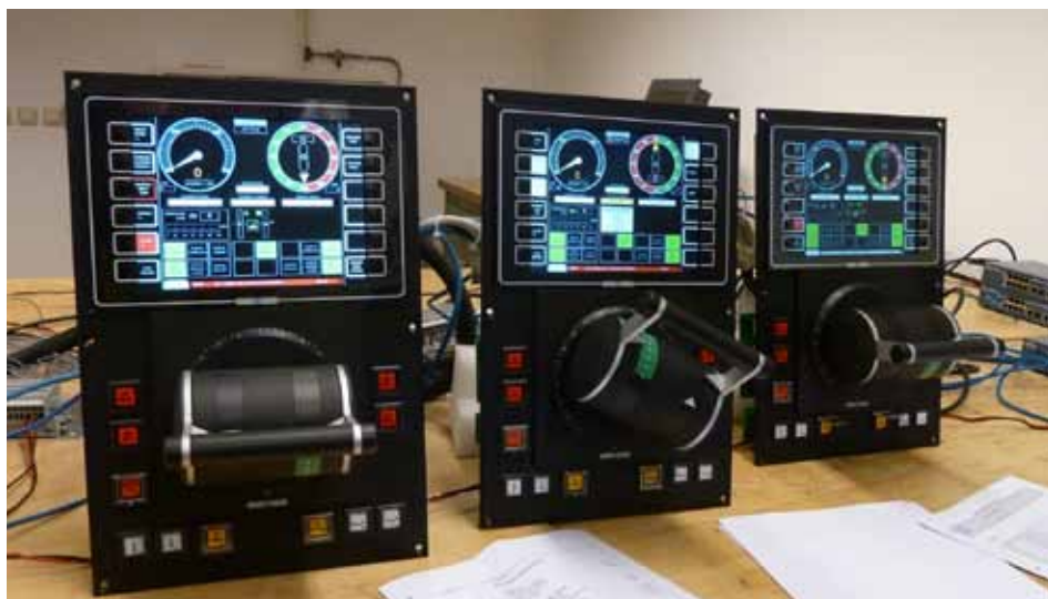
Panele systemu napędowego statku.
