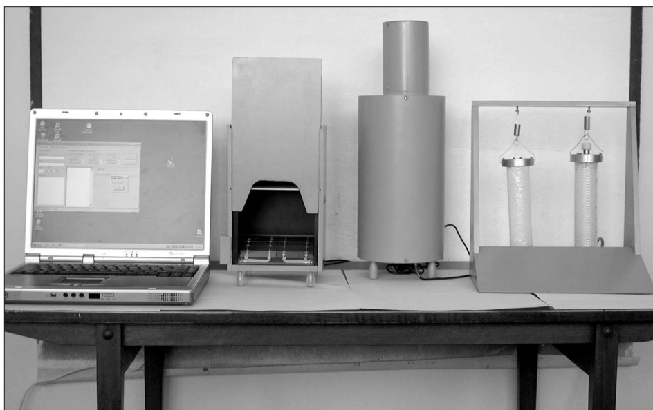
Stanowisko badawcze do oceny sprawności ręki. Od lewej: laptop z mikrokomputerowym systemem pomiaru oraz urządzenia do pomiaru rzutu ręki na płaszczyznę, do pomiaru zakresu ruchu zamykającej się ręki i do pomiaru ciśnienia zamykającej się ręki.
