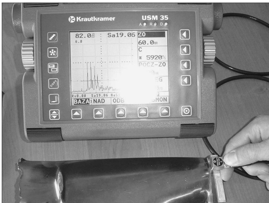
Defektoskop ultradźwiękowy podczas badań uszkodzonej łopatkki.
