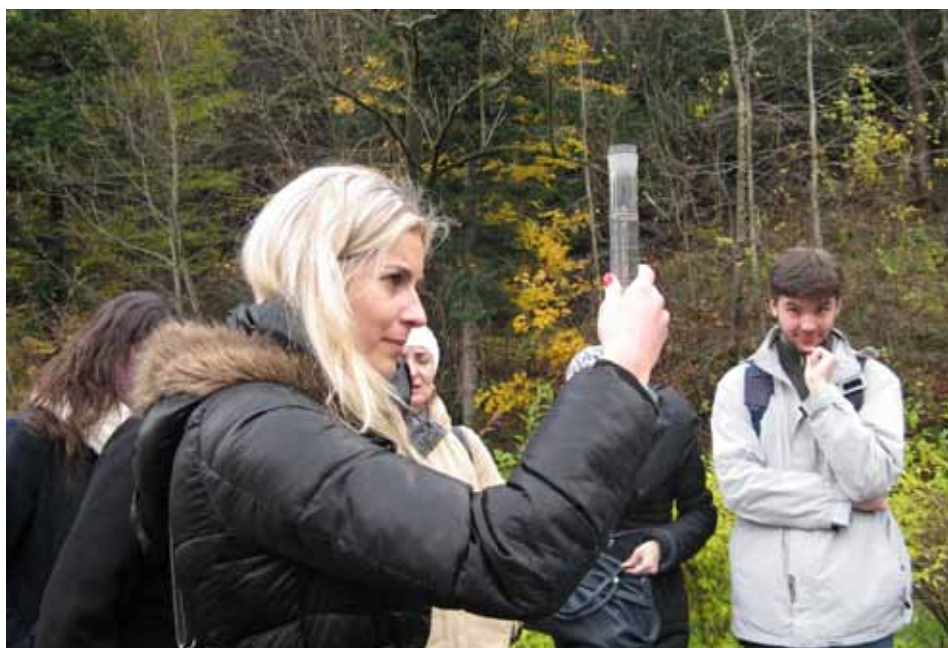
Oznaczanie zawartości dwutlenku węgla w wodzie aparatem KARAT.
