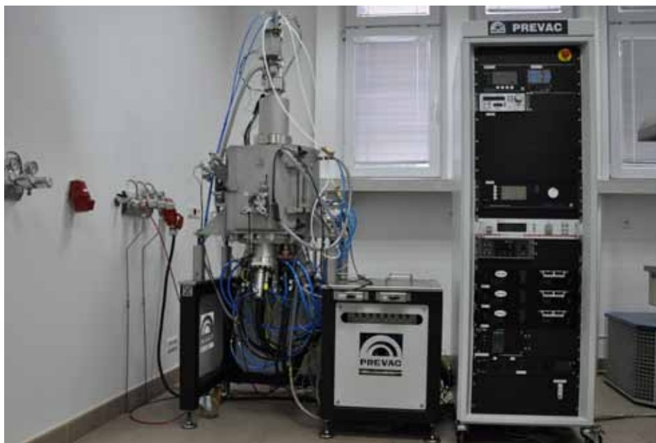
Napylarka próżniowa (PVD system PREVAC) w Laboratorium HYBRID w ZSEiT. Fot. P. Jankowski-Mihułowicz
